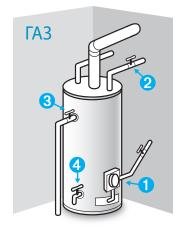
Запустите воздух вовнутрь водонагревателя. Вы можете сделать это, открыв разгрузочный клапан (переверните рукоятку таким образом, чтобы она смотрела прямо вверх или выступала наружу), расположенный на боковой стенке бака, или открыв кран с горячей водой в главной гостиной или на верхнем этаже вашего дома. Это поспособствует высвобождению воды из вашего водонагревателя.
